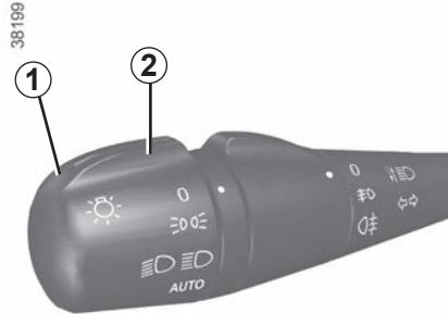
Når motoren og lysene er slått av og ringen er 2 i posisjon 0, drar du spaken 1 mot deg. Nærlysene tennes i rundt 30 sekunder. Du kan forlenge denne tiden ved å dra i spaken opptil fire ganger (total tid er begrenset til rundt to minutter). Meldingen "— —" sammen med tiden lysene skal være på, vises i instrumentpanelet for å bekrefte denne handlingen.
