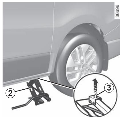
Sett inn jekken 2 horisontalt. Jekkens hodebolt 3 skal være på linje med hullet i nedre del av karosseriet nærmest hjulet det gjelder.
