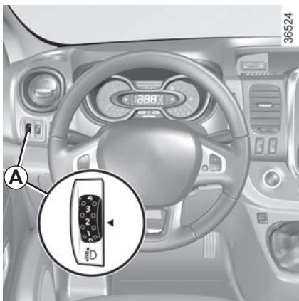
På kjøretøy med denne funksjonen brukes kontroll **A** til å justere høyden på strålene i henhold til lasten.
