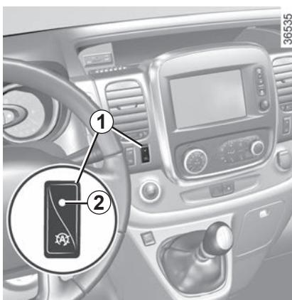
Trykk en gang til på knappen for å reaktivere systemet. Meldingen "STOP AND START ACTIVATED" vises i instrumentpanelet og den integrerte varsellampen **2** på bryteren **1** slukker.
