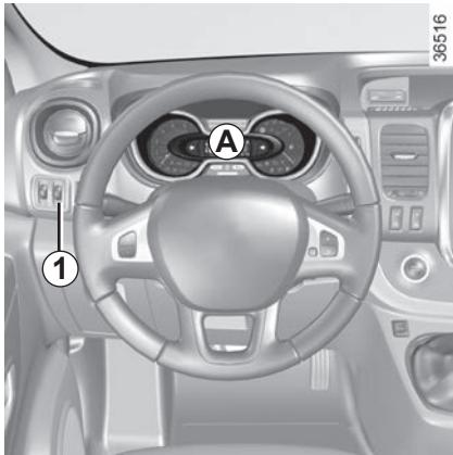
**Instrumentpanelet A** tennes når tenningen slås på. Lysstyrken kan justeres ved å vri kontrollknott 1.
