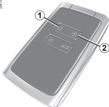
Hvis kjøretøyet har en funksjon for superlåsing, kan du låse dørene og hindre at dørene låses opp med håndtakene innvendig (for eksempel ved å knuse vinduet og prøve å åpne døren fra innsiden).
