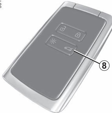
Hvis en dør åpnes eller lukkes **mens motoren går**, og kortet ikke lenger er i sonen **5**, viser meldingen "Nøkkelskort ikke igjenkjent" at kortet ikke er inne i kjøretøyet. Dette hindrer for eksempel at du kjører av gårde etter at du har sluppet av en passasjer som har kortet med seg.
