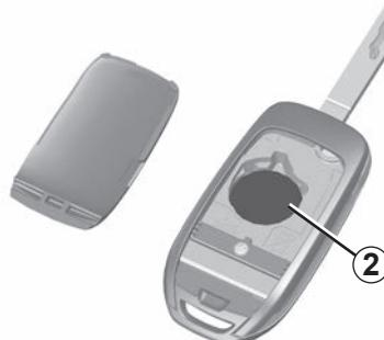
**Merk:** Det anbefales at du ikke berører den elektroniske kretsen i nøkkeldekselet når du skifter batteriet.
