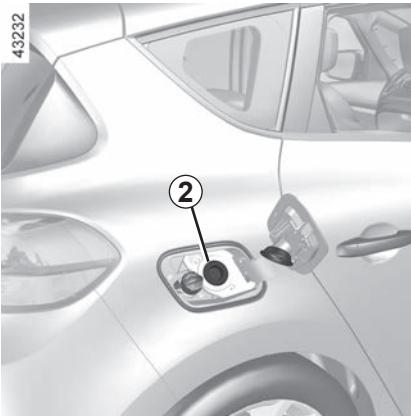
For å hindre at det fylles blyholdig bensin på tanken har påfyllingsrøret en hindring med et sikkerhetssystem som **tillater at bare dyser for blyfri bensin blir brukt** (på pumpen).
