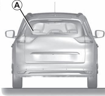
Med QR-koden på **A**-etiketten kan nødhjelpmannskapene bruke et nettbrett eller en smarttelefon slik at de umiddelbart får tilgang til teknisk informasjon som er nyttig for arbeid på kjøretøyet i tilfelle en ulykke.
