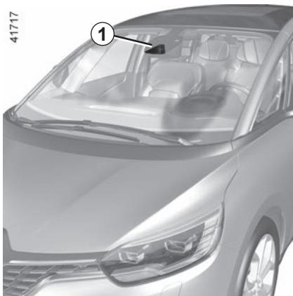
Ved å bruke informasjonen fra radar-kameraet **1** varsler denne funksjonen føreren om tidsintervallet mellom føren- ren og kjøretøyet foran slik at det kan opprettholdes en trygg bremselengde mellom de to kjøretøyene.
