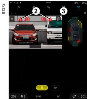
Registrering av faste hindringer bak
