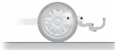
Eventuelle taueenheter må ikke hindre noen lyskomponenter eller nummerskiltet når det ikke er i bruk. Mekaniske taueenheter (kule, krok osv.) som kan fjernes uten verktøy eller som er uttrekkbare, må fjernes eller flyttes når de ikke er i bruk.
