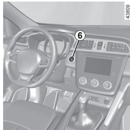
Hvis instrumentpanelet viser miles: (alternativ for å skifte til km/t)
