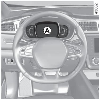
**Instrumentpanel A:** Denne lyser når førerdøren åpnes.
