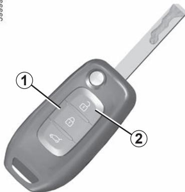
Hvis kjøretøyet har en funksjon for superlåsing, kan du låse åpnelementene og hindre at dørene kan låses opp med de innvendige håndtakene (for eksempel ved å knuse vinduet og forsøke å åpne døren fra innsiden).
