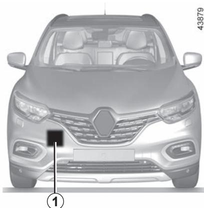
Systemet beregner avstanden til kjøretøyet foran ved hjelp av **1**-føleren og varsler føreren hvis det er fare for påkjørsel bakfra. Føreren har dermed mulighet til å bremse ned kjøretøyet for å begrense skadene ved et eventuelt sammenstøt.
