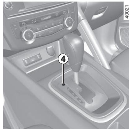
**Hvis funksjonen er aktivert** og girspaken sitter fast i **P**, må du trykke inn bremsepedalen. Det er mulig å frigjøre spaken manuelt. Det gjør du ved å sette inn et verktøy (med en stiv stang) i sporet **4** og løsne girspaken.
