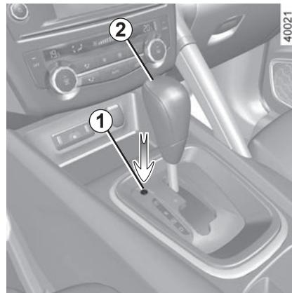
Hvis girspaken sitter fast i **P**, selv når du trykker inn bremsepedalen, kan den utløses manuelt. Det gjør du ved å løsne sokkelen til girspaken og sette inn et verktøy (med en stiv stang) i sporet **1**. Trykk samtidig inn knappen **2** for å løsne girspaken.
