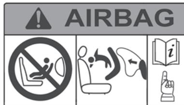
Merkene på dashbordet og etikettene **A** på hver side av solskjermen for passasjeren **3** (for eksempel etiketten som vises ovenfor) minner deg på disse instruksjonene.
