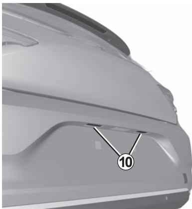
LED-lys for nummerskilt 10 (kjøretøyavhengig)
